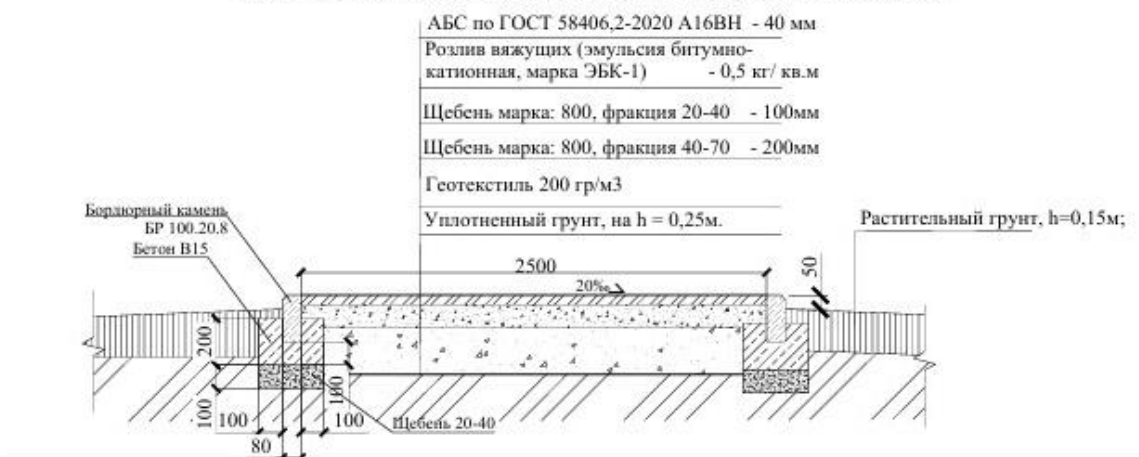
Конструкция покрытия тротуаров из асфальтобетона, тип 1
